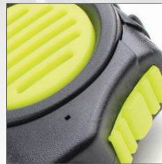
Große Sendetaste (PTT) und seitliche Sendetaste der Yellow-Version.
